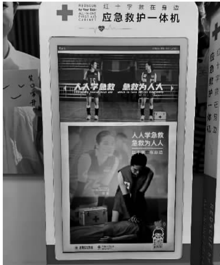
红十字应急救护一体机”是由中国红十字基金会研发的，集合AED、急救包、交互大屏于一体的应急救护设备
